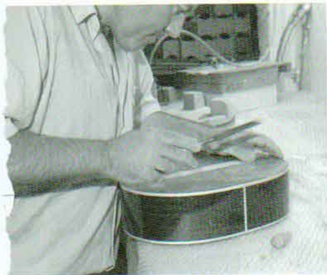
写真上：ブリッジを貼る位置の塗装を注意深く削がす。(ライムンド社 Photo: Mercho Gonzalez Heran)
