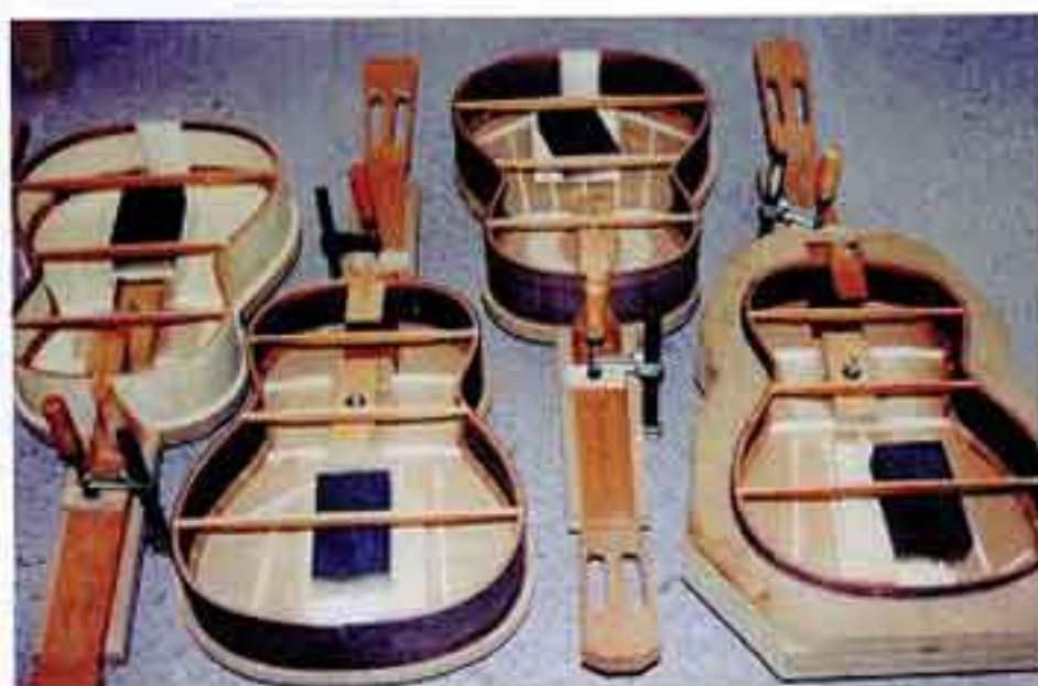
スペイン式組立型による工法。右側は外型も併用。表面板中央に乗っている黒い物は表面板のドーム形状(膨らみ)を保つための重し(カッリジョ工法)
