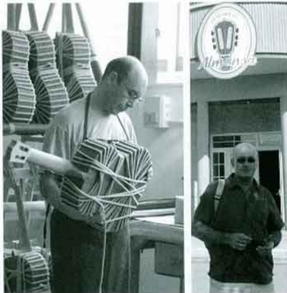
写真左上：取材時に説明するピセンテ・カリョ社長 写真左下：通常はカ木の下になるブリッジ・プレートを上にして表面板との接触を最小限にしている。これこそ本場のブリッジ（橋）？（アルマンサ工場） 写真中央：伝統的なロープ巻き方式によるバインディング。パーフリング接着。スペース効率が良いことも量産では重要な（アルマンサ工場 Photo:Merche Gonzalez Herren） 写真右：アルマンサ工場入口前にてペドロ・アンヘル・ロベス社長（Photo:Merche Gonzalez Herren）
